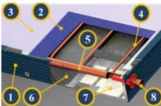
1. Perfil de aluminio con recubrimiento en polvo prot. máxima z. costeras.
